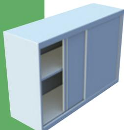
Ossature inox brossée 304L, assemblage par panneaux pliés soudés, 2 portes coulissantes en façade inox montées sur rails et montures à galets invisibles avec frein de fin de course. Étagère intérieure réglable en hauteur, 1 plancher bas.
