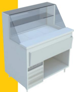
Fabrication tout inox poli, joues inox miroir, façade verre sécurit basculant, 2 niveaux de verre avec éclairage en sous face. 1 plateau de présentation amovible, évaporateur ventilé. Circulation d'air pulsé à 4 °c en surface. Soubassement local technique groupe à air logé ; une étagère basse. Façade adaptée pour recevoir un panneau décor. Livré avec façade inox.
