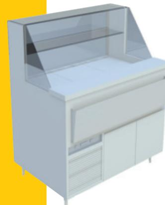
Fabrication tout inox poli, joues inox miroir, façade verre sécurit basculant, 2 niveaux de verre avec éclairage en sous face. 1 plateau de présentation amovible, évaporateur ventilé. Circulation d'air pulsé à 4 °c en surface. Soubassement local technique avec groupe à air logé ; réserve réfrigérée à portillons fermeture par joints magnétiques évaporateur ventilé. Façade adaptée pour recevoir un panneau décor. Livré avec façade inox.
