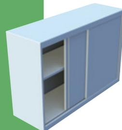
Ossature inox brossée 304L, assemblage par panneaux pliés soudés, 2 portes coulissantes doublées inox montées sur rails et montures à galets invisibles avec frein de fin de course. Étagère intérieure doublée réglable en hauteur, 1 plancher bas.
