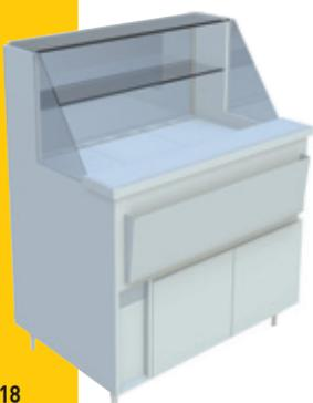
Fabrication tout inox poli, joues inox miroir, façade verre sécurit basculant, 2 niveaux de verre avec éclairage en sous face. 1 plateau de présentation amovible, évaporateur ventilé. Circulation d'air pulsé à 4 °c en surface. Soubassement local technique ; réserve réfrigérée à portillons fermeture par joints magnétiques évaporateur ventilé. Façade adaptée pour recevoir un panneau décor. Livré avec façade inox;
