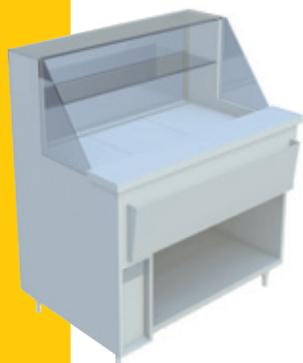
Fabrication tout inox poli, joues inox miroir, façade verre sécurit basculant, 2 niveaux de verre avec éclairage en sous face. 1 plateau de présentation amovible, évaporateur ventilé. Circulation d'air pulsé à 4 °c en surface. Soubassement local technique ; une étagère basse. Façade adaptée pour recevoir un panneau décor. Livré avec façade inox;
